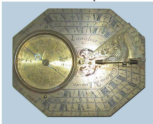
Le style mobile est gradué en degrés (de 40° à 60°), ce qui permet de le placer à la latitude du lieu pour lequel il est utilisé.
