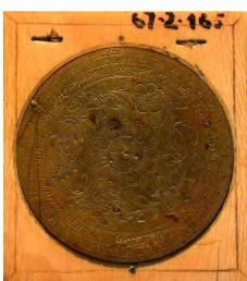
Venons-en à l'utilisation de ce cadran : Ici, c'est l'ellipse qui est mobile, et le style : la boussole, qui est fixe. On commence par marquer la date, grâce au calendrier qui se trouve sous le diptyque ; on tourne le calendrier jusqu'à ce que la date d'utilisation soit devant l'index matérialisé par un téton. On place alors le couvercle en position verticale et on l'oriente vers le Soleil ; lorsque son ombre tombe exactement sur la base, la boussole indique l'heure.
